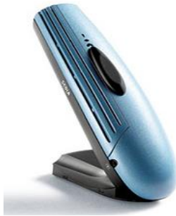
Imagen número 4: Fotografía referencial de Transmisor FM tipo micrófono ambiental.
