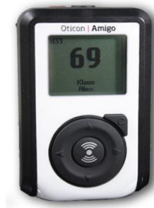
Imagen número 5: Fotografía referencial de Transmisor FM dispuesto en el orador.
