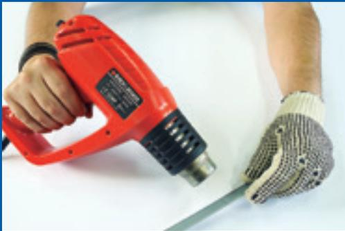
Doblar el material donde se realizó la marca usando la pistola de calor.
