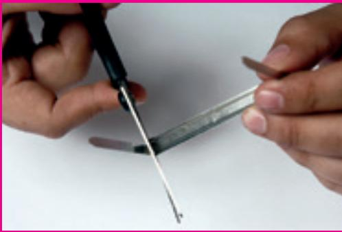
Tomar el acoclip y separar el cuerpo principal de la estructura en forma de U. Cortar sus extremos laterales a ras.
