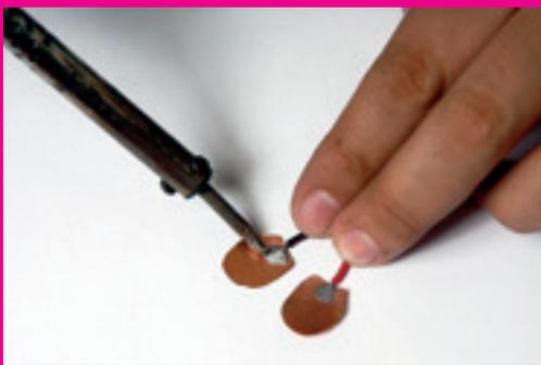
Soldar el cable paralelo a los trozos de cobre.
