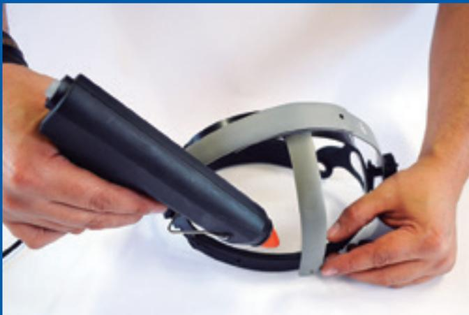
Ubicar las abrazaderas estiradas sobre la estructura de la máscara y formar una especie de casco cruzándolas y doblándolas. Realice la forma con la pistola de calor y fije con silicona.
