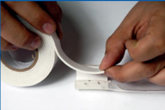
En la curva del ancho del tubo de pvc, agregar cinta de doble contacto en su cara interna.
