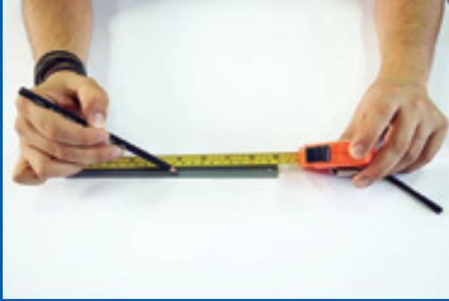
Marcar sobre la abrazadera estirada el largo correspondiente al adaptador universal.
