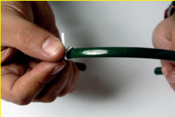
Fijar el encendido del puntero láser con cinta adhesiva y un botón que mantendrá presionado el on.
