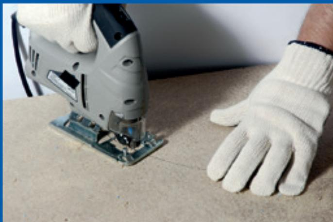
Cortar la escotadura con la sierra caladora y lijar con cuidado. Puede fijar la mesa con velcro a los apoya brazos de la silla de ruedas o atornillada a una silla postural.
