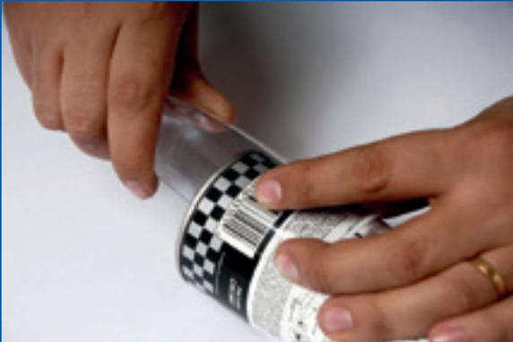
Calentar el trozo de plástico con la pistola de calor y moldear la curvatura del tobillo en su parte más ancha. Para facilitar el proceso, se recomienda usar como base la curva de una lata de bebida. El otro extremo debe angostarse hasta el ancho del tubo de pvc.
