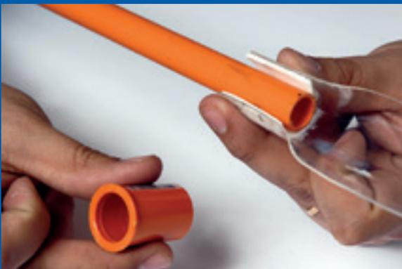
Sobre la cinta de doble contacto, pegar el tubo de pvc. Luego, poner la copla entre el tubo de pvc y la cinta de doble contacto, sosteniendo la estructura.
