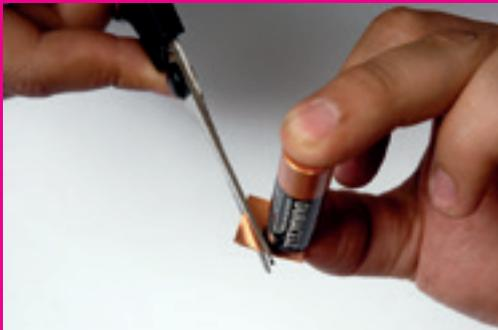
Cortar dos trozos redondos de láminas de cobre, equivalente al diámetro de una pila doble AA.
