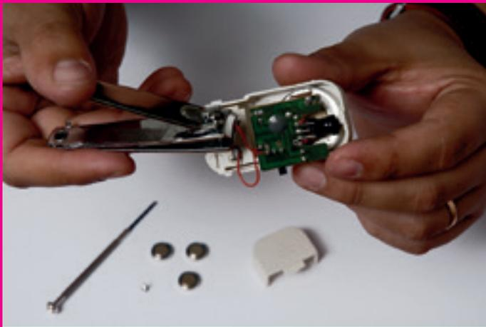
Tomar los cables que se encuentran entre las pilas y el interruptor on off, cortarlos por la mitad y pelar sus extremos usando el corta uñas.
