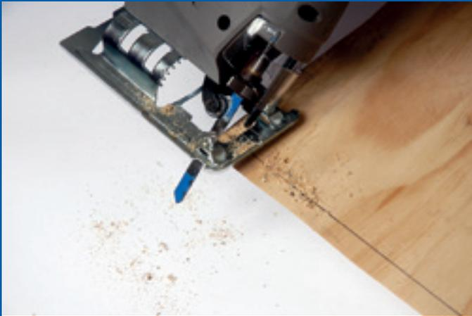
Hacer un corte en diagonal en  $45^\circ$  aprox desde la marca hasta el borde de la tabla. Repetir el paso en el otro extremo.
