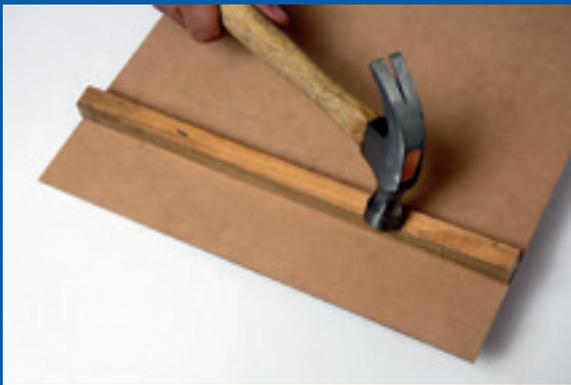
En una de las tablas, clavar el listón en forma paralela y por debajo del corte realizado.
