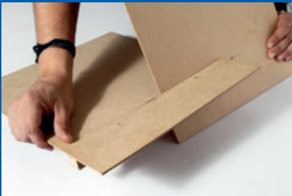
Ensamblar uniendo las tablas por las dos hendiduras dejadas por el corte, de modo que la tabla del eje vertical tenga el listón mirando para adelante.
