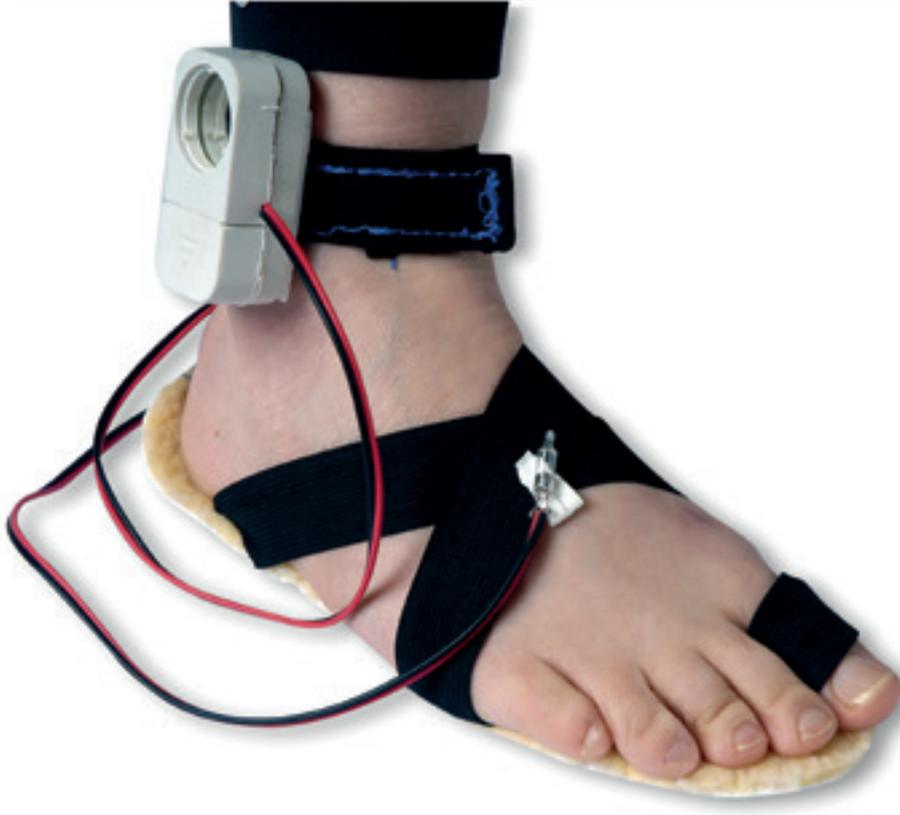
DESCRIPCIÓN: Es un dispositivo de feedback para el entrenamiento de la marcha, reforzando el movimiento talón punta.
