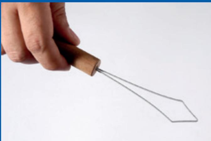
Introducir el alambre en la perforación del palo de escoba. Puede aumentar la seguridad del agarre con una tachuela como muestra la foto.
