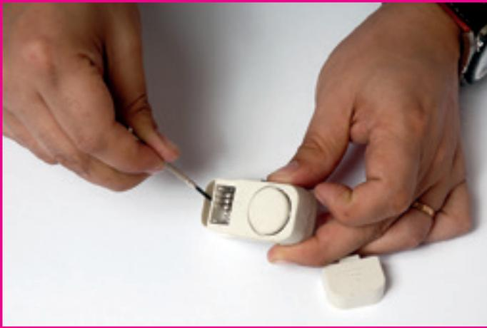
Sacar las pilas de la alarma y buscar el tornillo que se encuentra bajo ellas. Abrir la alarma
