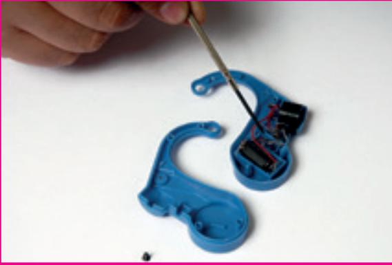
Tomar la alarma con sensor de movimiento, sacar el tornillo y abrir. En su interior encontrará 3 pilas de reloj, una cápsula de vidrio con mercurio y una bobina sonora.
