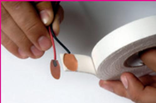
Pegar cinta doble contacto en medio de los dos trozos de cobre soldados con los cables.
