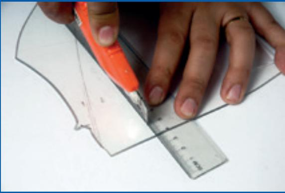
Habiendo tomado un molde de la curvatura del tobillo por su parte posterior, marcar el plástico y cortar.
