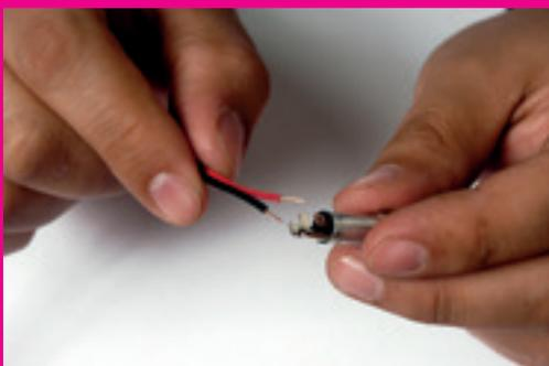
En el otro extremo del cable soldar el jack 3,5 mono (sacar vaina plástica la cual en su interior encontrará dos conectores).
