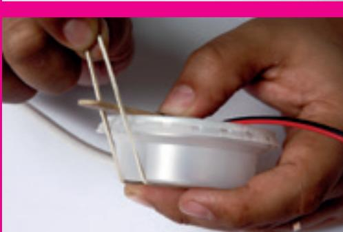
Cerrar el pocillo y poner el palo de helado sobre el metal. Sostener la estructura con un elástico enganchado en los extremos del palo de helado y pasando por la parte inferior del pocillo como muestra la foto.
