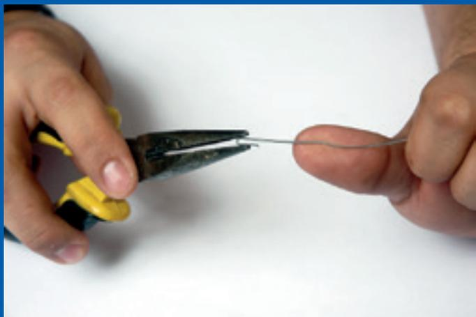
Cortar dos trozos de alambre galvanizado, con 2 cm. menos de la medida de los cordones de zapatos.
